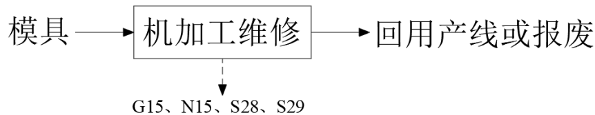
图 2-6 模具维修流程及产污环节图
