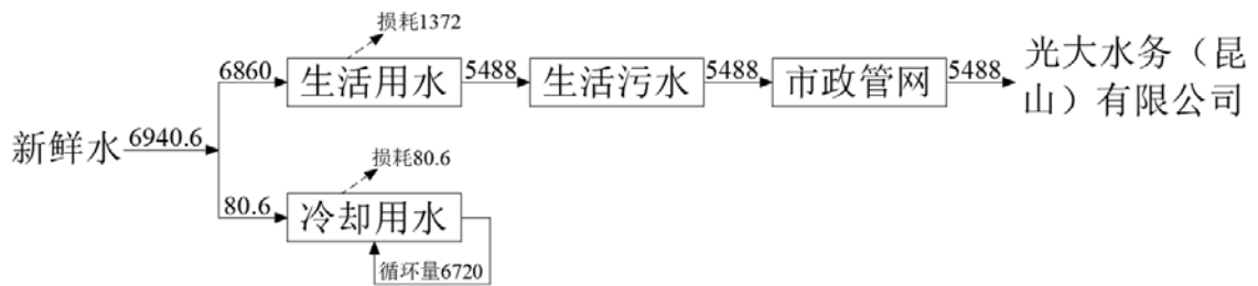
图 2-1 本项目建成后全厂水平衡图（单位：m 3 /a）
