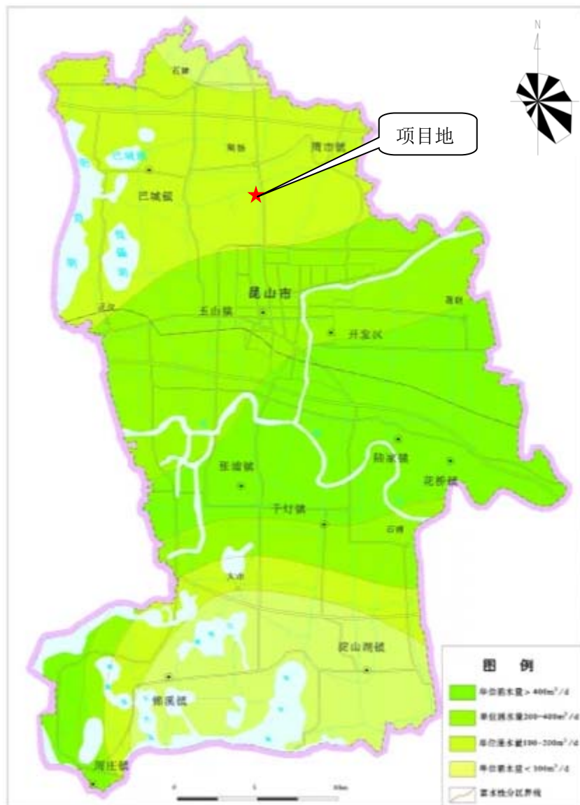
图6.7-9 昆山市微承压含水层富水性分区图
